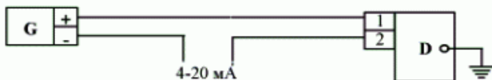
а) Датчик с выходным сигналом 4 - 20 мА, 2-проводная линия
